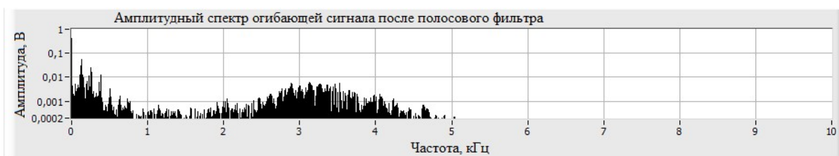
Рис.10. Спектр огибающей комплексного колебания на выходе ПФ
