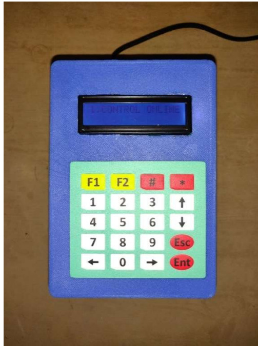
Рис. 4. Образец микроконтроллерной системы защиты асинхронного электродвигателя до 1000 В
